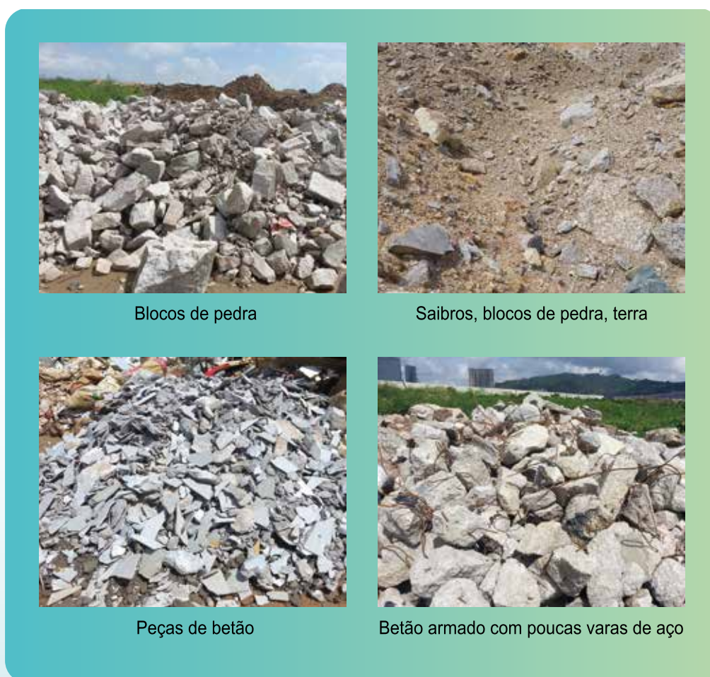
Figura 5 - Materiais inertes resultantes da demolição e construção
